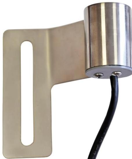
Датчик уровня воды настенный предназначен для сигнализации уровня электропроводных жидкостей. Принцип действия датчика основан на разнице между электропроводностью воздуха и жидкости.
